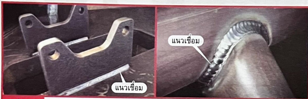
รูปที่ 11.1 การประกอบแบบถาวรโดยการเชื่อม
